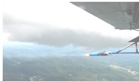
ภาพที่ 2.17 แสดงติดตั้งอุปกรณ์สำหรับพลุสารดูดความชื้นและการใช้พลุสารดูดความชื้นเครื่องบิน AU23A (ซ้าย) และรูปแบบการบินในการใช้พลุสารดูดความชื้น (ขวา)
