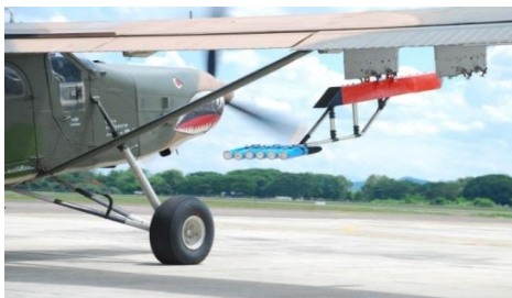
ภาพที่ 2.17 แสดงติดตั้งอุปกรณ์สำหรับพลุสารดูดความชื้นและการใช้พลุสารดูดความชื้นเครื่องบิน AU23A (ซ้าย) และรูปแบบการบินในการใช้พลุสารดูดความชื้น (ขวา)
