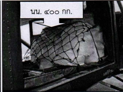
ภาพที่ ๑๐ ลักษณะการเรียงสารฝนหลวงบนอากาศยานชนิด AU-๒๓
