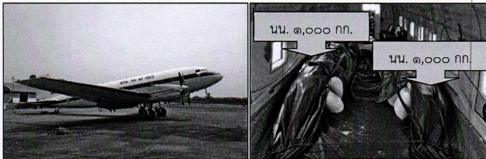
ภาพที่ ๙ ลักษณะการเรียงสารปนหลวงบนอากาศยานชนิด BT-๖๗
