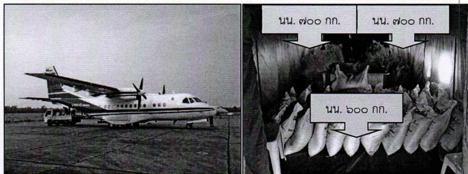
ภาพที่ ๗ ลักษณะการเรียงสารปนหลวงอากาศยานชนิด CN-๒๓๕
